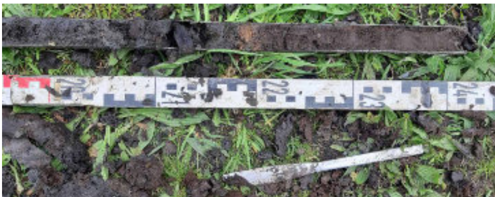
Foto OSW-07 Boring Bz6B3054 (SWo3). Veen, roodbruin, matig amorf, rietdoorworteld van boven, mogelijk oligotroof veen; tussen 4,0 en 4,1 m: stukje hout (verslagen, antropogeen?); vanaf 4,1 m: gyttja (Zaanaafzetting), donkerbruin, met fijne plantenresten, op 4,15 gele wortelbaard.
