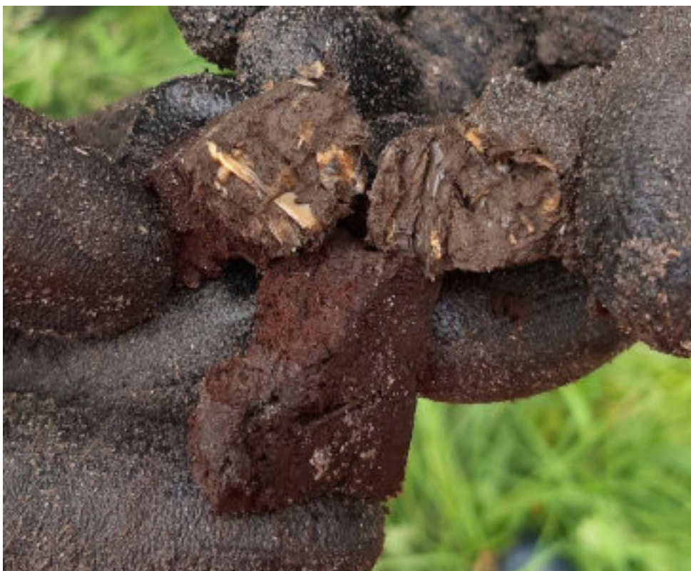
Foto ZB-08 Boring B25B3066 (veldnummer ZBo1). Detailopname van humeuze klei met riestengels, erosief op roodbruin oligotroof veen met veenmos en heide.
