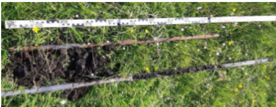
Foto EW-01 Boring B25B3057 (EW03). Klei, grijsbruin, matig humeus met zandnesten; vanaf 0,45 m: veendetritus (meerbodema-fzetting), donkerbruin, verslagen Hollandveen, losse structuur, heidetakje en ook rietresten, niet doorworteld; vanaf 1,17 m: klei (Wormer-a-fzettingen), zwak humeus, licht bruingrijs, slap, licht doorworteld; vanaf 1,2 m: klei, blauwgrijs, gelaagd met uiterst dunne zandlaagjes; vanaf 1,4 m: zand, zeer fijn, grijs.
