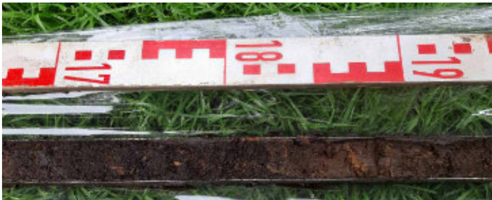
Foto ZB-13 Boring B19D2116 (veldnummer ZBo7). Veen, donkerbruin, matig amorf, rietveen; vanaf 1,83 m: veen, kleiig, grijsbruin, riet; vanaf 1,90 m: veen, donkerbruin, rietveen, redelijk tot goed ontwikkeld.
