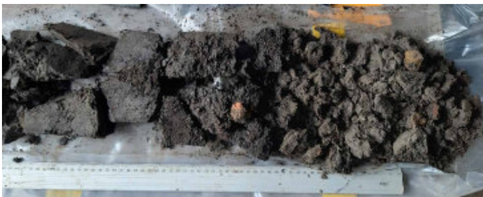
Foto WS-32 B3033 (B6). Kern 6,5-7 m –MV. Klei, sterk humeus, donker bruingrijs, rietresten, detritus, met brokkenveen, gyttja-achtig, vanaf 6,85 m: zand, donkerbruin, spoor baksteen, veendetritus en losse structuur.
