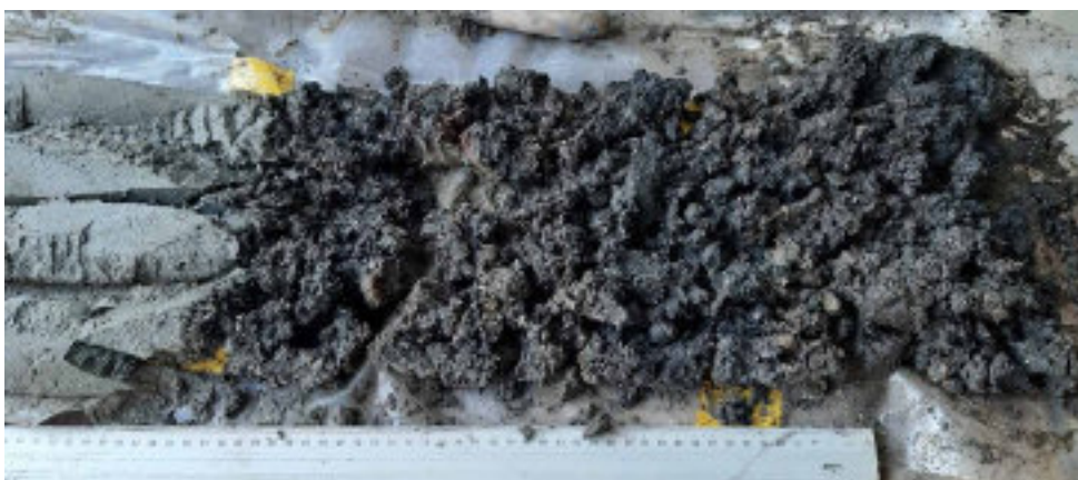
Foto WS-50 Boring B25B3039 (WSB14). Kern 7,5-8 m –MV. Puin, korrelig materiaal van slakken en sintels, wat kleiig, grijszwart.
