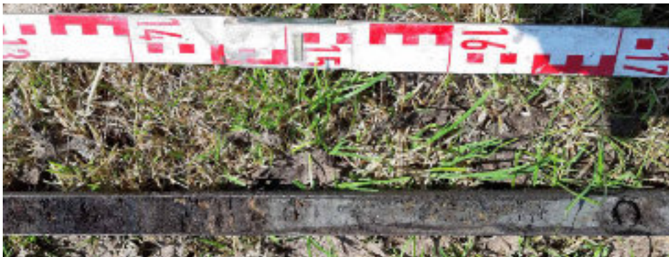
Foto SM-07 Boring B19D2103 (SM09). Veen (basis Hollandveen), donkerbruin, rietveen, redelijk ontwikkeld; vanaf 2,62 m: klei (Wormerafzetting), licht bruingrijs, matig slap, licht rietdoorworteld; vanaf 2,85 m: klei, blauwgrijs, matig slap, licht rietdoorworteld.
