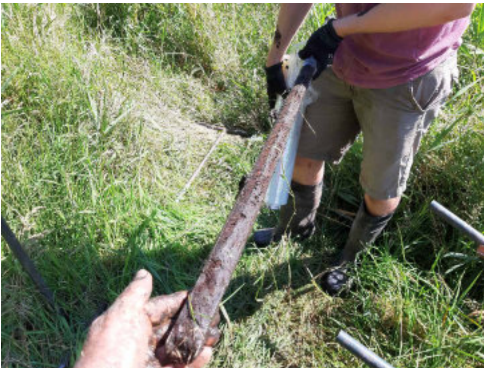
Foto ZB-18 Bemonstering van de gutskern van boring B19D2112 (ZBo3).
