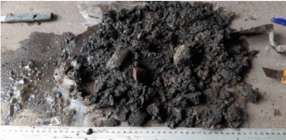
Foto WS-10 Boring B25B3030 (WSBo3). Kern 1,5-3 m –MV. Zand, donker bruinzwart, puinresten; opbrengst 35 cm, met organisch materiaal, baksteen en grind; basis lichtbruin zand (voor de boorbeschrijving, zie: https://www.dinoloket.nl/ondergrondgegevens ).
