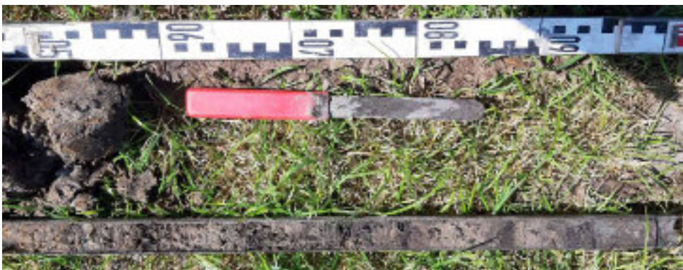
Foto SM-02 Boring B19D2100 (SM06). Klei, bruingrijs, met lichtgrijze zandlaagjes, uiterst fijn zand; vanaf 0,7 m: zand, geelgrijs, zeer fijn, weinig ijzeroxide, gelaagd op humeusiteit.
