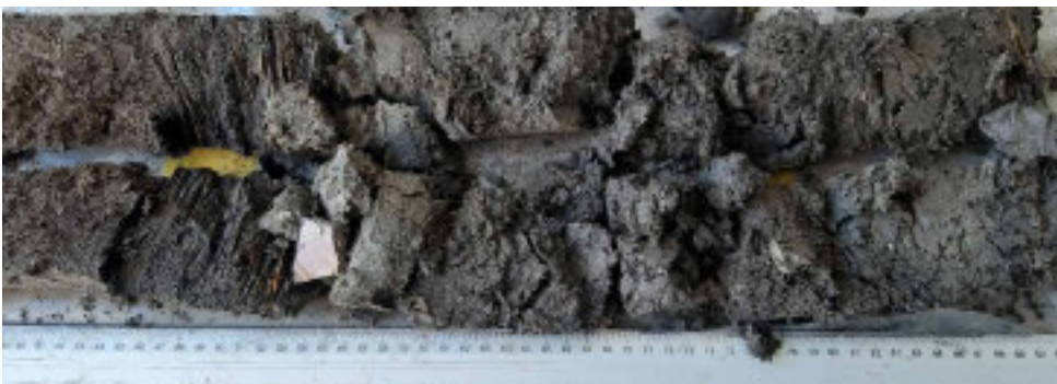
Foto WS-61 Boring B25B3042 (WSB17). Kern 4,40-4,91 m –MV. Veenbrok, zwak kleiig, donkerbruin, amorf, Opm.: op 4,48-4,58 m rietmat; vanaf 4,58 m: zand, grijs, matig fijn, aardewerkfragment, geglaazuurd aardewerk, deel baardmankruik.
