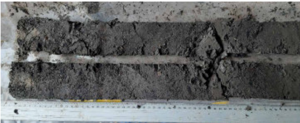
Foto WS-37 Boring B25B3033 (WSBo6). Kern 9-9,5 m –MV. Klei, donker bruingrijs, rietresten, veel detritus, spoor zoetwater en landschelpen.
