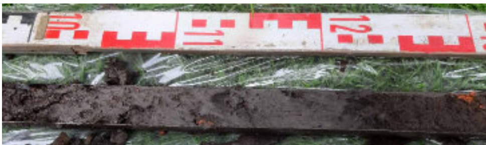
Foto ZB-11 Boring B19D2116 (veldnummer ZBo7). Klei, grijs, zwak humeus, matig stevig, brokkelig, stukje baksteen (rood) en enkel fijn grindje, naar onderen toe slapper en gladde klei, niet meer brokkelig – opgebrachte klei?; vanaf 1,22 m: veen, zwak kleilig, donkerbruin, rietveen, redelijk ontwikkeld.
