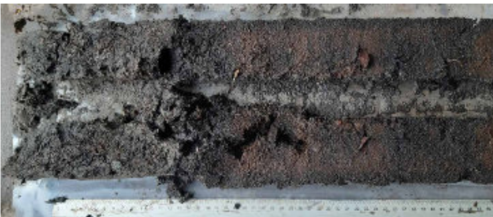
Fot o WS-15 Boring B25B3030 (WSBo3). Kern 5-5,5 m –MV. Veendetritus (Zaanaafzetting), kleiig, zandig, donker-bruingrijs, spoor baksteen en smerig. Vanaf 5,15 m: veen (Hollandveen), donker bruinzwart, top geoxideerd; 5,18 m: veen, donkerbruin, rietwortels, takjes, berk (mesotroof?); vanaf 5,35 m: veen, donker- en roodbruin, oligotroof, heide.
