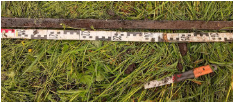
Foto ZB-03 Boring B25B3066 (veldnummer ZBo1). Klei, licht bruingrijs, matig humeus; vanaf 2,15 m: veen, donkerbruin, vrij droog, met zeer fijne zandkorrels; vanaf 2,35 m: klei, grijsbruin, venig, rietdoorworteld, vrij stevig.
