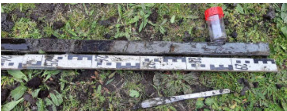
Foto OSW-09 Boring B26B3054 (SWo3). Zand, zeer fijn, grijs, detritus, gelaagd met detritus, basis erosief, vanaf 5,57 m: veen (Hollandveen), zwart, rietveen (rietveen in zwarte matrix); vanaf 5,63 m: klei (Wormerafzetting), licht bruingrijs, rietdoorworteld, vanaf 5,8 m: klei, blauwgrijs, slap.
