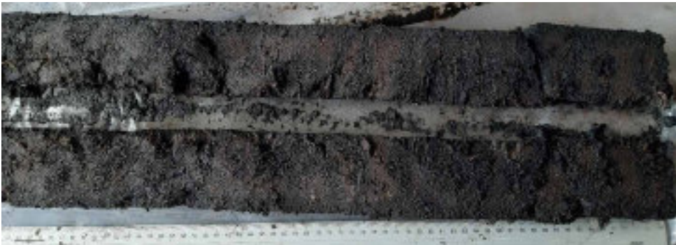
Foto WS-16 Boring B25B3030 (WSB03). Kern 5,5-6 m –MV. Veen (Hollandveen), donkerbruin, oligotroof, beetje roodbruin in de kern, heide.
