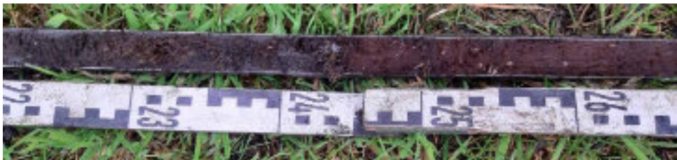
Foto ZB-09 Boring B19D2112 (veldnummer ZBo3). Veen, bruin, goed ontwikkeld rietveen, basis donkerbruin en riet riozoom, vanaf 2,4: veen roodbruin, oligotroof veen met wollegras en veenmos, naar onder toe amorf.
