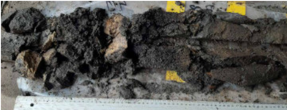
Fot o WS-13 Boring B25B3030 (WSBo3). Kern 4-4,5 m –MV. Zand, donkergrijs, uiterst fijn, smerig en gele baksteen; vanaf 4,15 m: veendetritus, kleiig, donkerbruin en houtresten; op 4,46 m: rietstengels.
