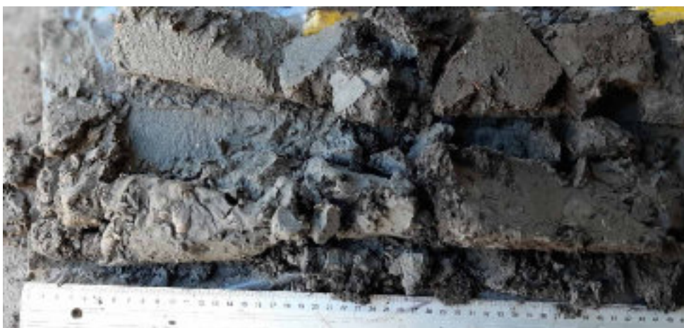
Fot o WS-53 Boring B25B3039 (WSB14). Kern 9,5-10 m –MV. Klei, sterk humeus, donker bruingrijs, amorf/gyttja-achtig materiaal, met wortelresten.
