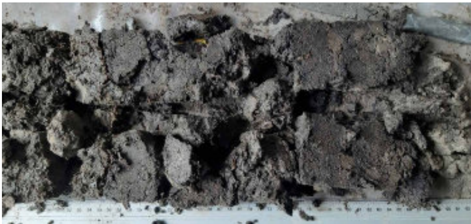
Foto WS-30 Boring B25B3033 (B6). Kern 5,5-6 m –MV. Klei, sterk humeus, licht bruingrijs, rietresten, veel detritus, vanaf 5,75 m: veenbrok, donkerbruin, rietveen, stevig en compact, basis kleibrokken.
