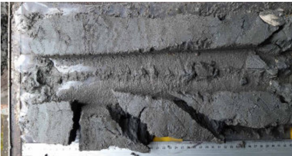
Foto WS-46 Boring B25B3039 (WSB14). Kern 5-5,5 m –MV. Zand (ophoogzand), kleiig, uiterst fijn, grijs, iets humeus, spoor detritus, met kleibandjes, zwak ontwikkeld; vanaf 5,30 m: zand, kleiig, uiterst fijn, grijs, weinig Cerastodermaedule, weinig Scrobicularia plana, schelpen enkelkleppig homogeen.
