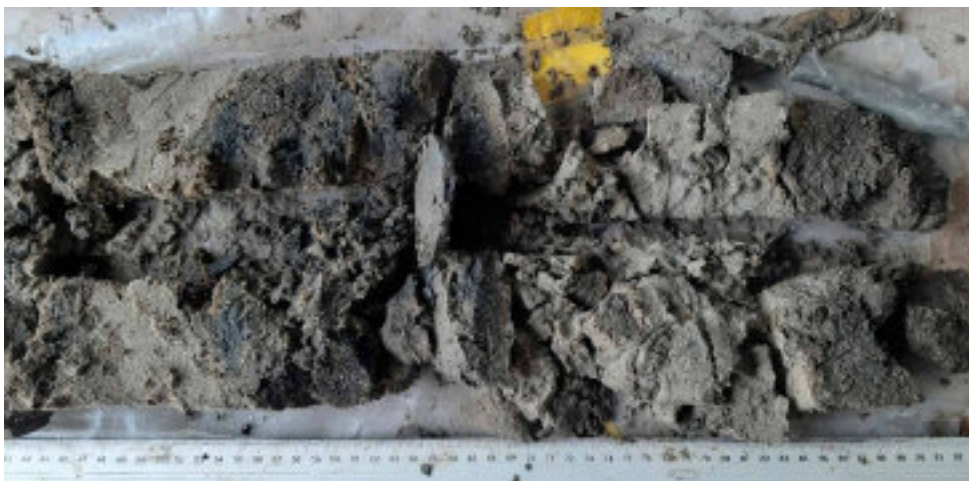
Foto WS-34 Boring B25B3033 (B6). Kern 7,5-8 m –MV. Zand, uiterst fijn, zwak humeus, gelaagd met detritus, spoor schelpgruis, spoor baksteen; op 7,65 m: plat stuk leisteen, vanaf 7,85 m: brok veen, veel wortels.
