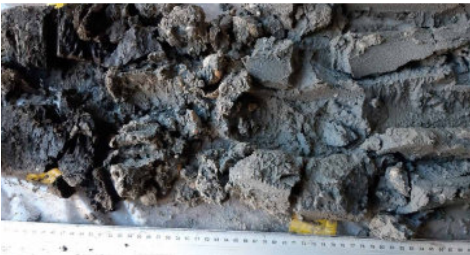
Foto WS-59 Boring B25B3039 (WSB14). Kern 12,5-13 m –MV. Zand en schelpen, matig fijn, veel Cerastoderma edule , enkelkleppige schelpen.
