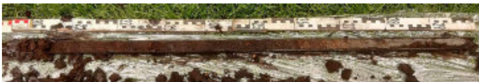
Foto ZB-14 Boring B19D2116 (veldnummer ZBo7). 2,85 m: veen, bruin en beetje rood, onduidelijk veen (mos/sphagnum aanwezig?), menyanthus zaadjes (mesotroof), riet riozoom; vanaf 3,35 m: veen, donkerbruin, amorf, rietveen; vanaf 3,57 m: veen, donkerbruin, rietveen, goed ontwikkeld; vanaf 3,70 m: veen, grijsbruin, kleiig rietveen; vanaf 3,75 m: klei (Wormerafzettingen), blauw-grijs, slap, rietdoorworteld.
