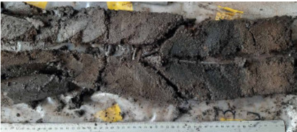
Fot o WS-14 Boring B25B3030 (WSBo3). Kern 4,5-5 m –MV. Verslagen veen, zwak kleiig, donkerbruin, houtresten en paaltje, loodrecht in het veen geslagen. Op 4,77-4,90 m verslagen veen, donker-zwartbruin, lijkt oligotroof.
