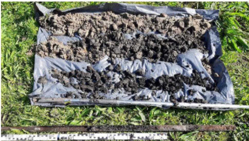
Foto OSW-04 Bovengrond van boring B26B3054 (SWo3), uitgeboord met de Edelman boor tot 2,75 m en van 2,75-3,40 m met de guts. Grond boven: zand, geelgrijs, matig fijn, grove korrels en spoor fijn grind, spoor schelpgruis, weinig baksteen, opgebrachte grond; vanaf 1,25 m (grond midden): zand, slecht gesorteerd, kleilig, sterk humeus, donkergrijs, zwartgevekt, schelpgruis, weinig baksteen en sintel; vanaf 2,0 m: zand, kleilig, sterk humeus, donkergrijs tot vuil grijs-zwart en venige brokjes; vanaf 2,60 m: klei, donkergrijs tot donker grijszwart, vuil, venige brokjes, stukjes hout (antropogene scheepswerflaag).
