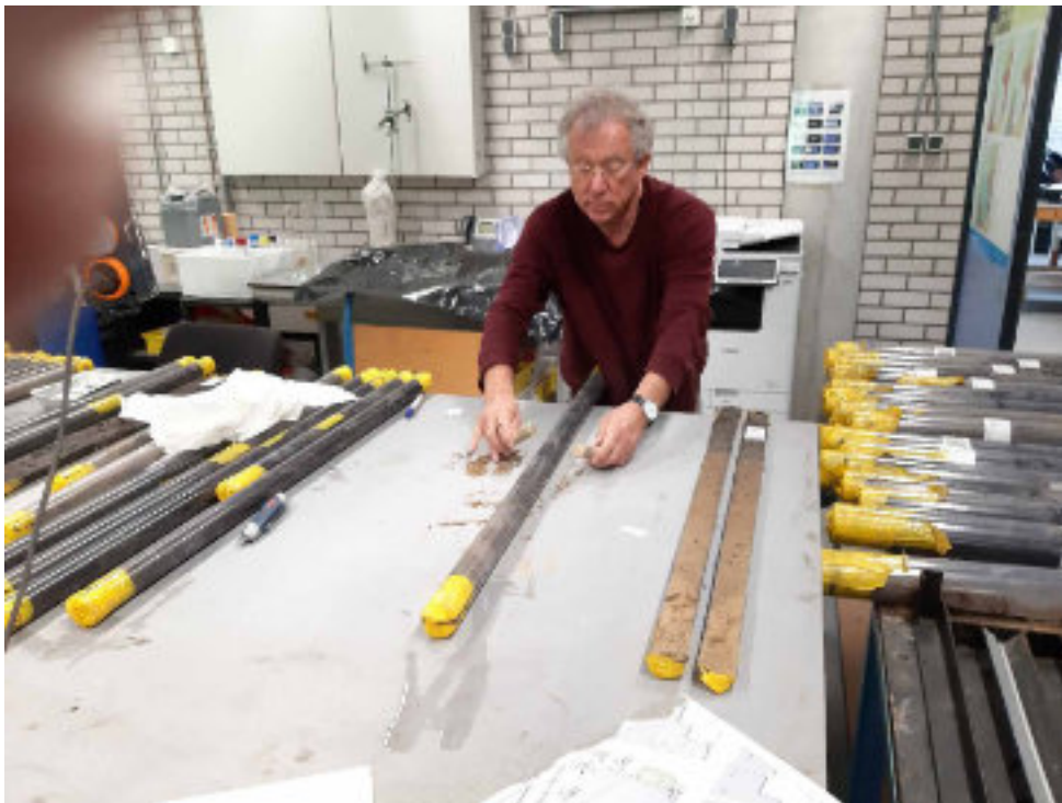
Foto OK-09 De boorkernen worden met een staal draadje gehalveerd en vervolgens geopend.
