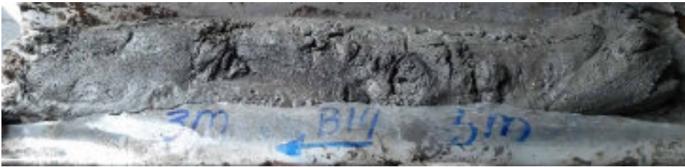
Foto WS-45 Boring B25B3039 (WSB14). Kern 3-5 m –MV. Zand (ophoogzand), uiterst fijn, kleiig, grijs, weinig Cerastodermadoubletten, spoor Mytilus doubletten, spoor Scrobiculariadoubletten, puinresten (baksteen, sintel en aardewerk), opgebracht Wormerzeezand; kern is versleurd, opbrengst is 80 cm.
