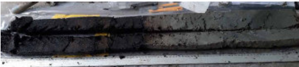
Foto WS-17 Boring B25B3030 (WSB03). Kern 6-7 m –MV. Vanaf 6,40 m: rietveen (Hollandveen), donkerbruin, matig amorf, stevig, vrij compact. Vanaf 6,50 m: klei (Wormerafzettingen), matig humeus, licht grijsbruin, rietwortels, matig stevig, vanaf 6,55 m: klei, matig humeus, licht grijsbruin, rietwortels, matig stevig, vanaf 6,88 m: zandig, licht groengrijs, spoor rietwortels, homogeen.
