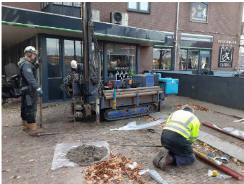
Foto WS-01 Uitvoering van sonicdrill boring B25B3O34 (WSBo7) in december 2020.
