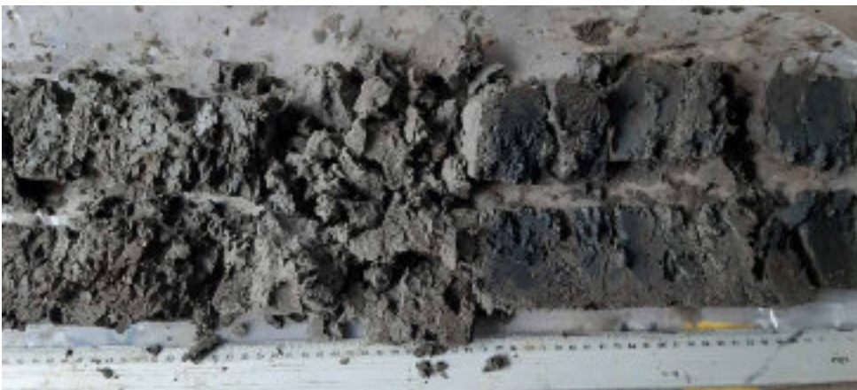
Foto WS-40 Boring B25B3033 (WSBo6). Kern 10,5-11 m –MV. Zand, grijs, uiterst fijn; vanaf 10,73 m: klei, sterk humeus, bruingrijs, veel detritus; zandlaagje op 10,88 m.
