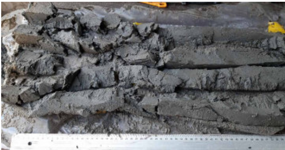
Foto WS-49 Boring B25B3039 (WSB14). Kern 7-7,5 m –MV. Zand (ophoogzand), uiterst fijn, grijs, zwak humeus; kern is versleurd met brokjes klei.
