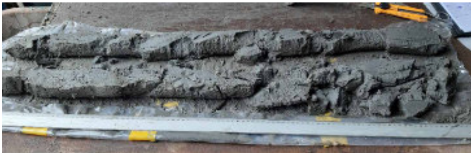
Foto WS-48 Boring B25B3039 (WSB14). Kern 6-7 m –MV. Zand (ophoogzand), zwak kleiig, grijs, spoor Cerastoderma edule en enkele Hydrobia ulvae.
