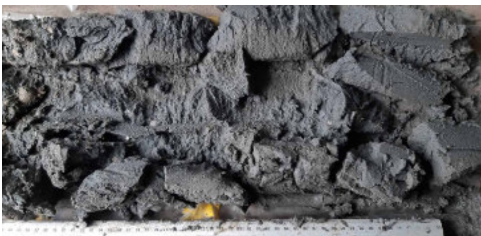
Foto WS-44 Boring B25B3033 (WSBo6). Kern 12,5-13 m –MV. Zand (Wormerafzettingen), zeer fijn, grijs, spoor schelpresten, homogeen.
