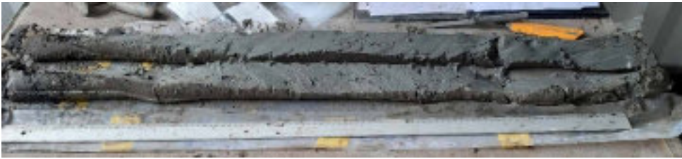
Foto WS-20 Boring B25B3030 (WSB03). Kern 7-8 m –MV. Zand (Wormerafzettingen), grijs, kleiig, uiterst fijn, spoor rietwortels en homogeen; vanaf 7,75 m: klei, zandig, grijs, weinig Scrobicularia plana doubletten, wadafzettingen.
