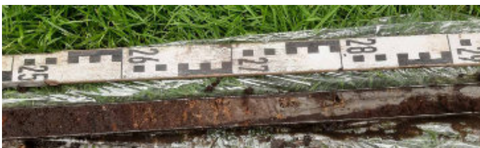
Foto ZB-16 Boring B19D2116 (veldnummer ZBo7). Detailopname foto ZB-14: traject tussen 2,55 tot 2,93 m: basis van de Hollandveenlaag, met daaronder de blauwgrijze Wormer klei
