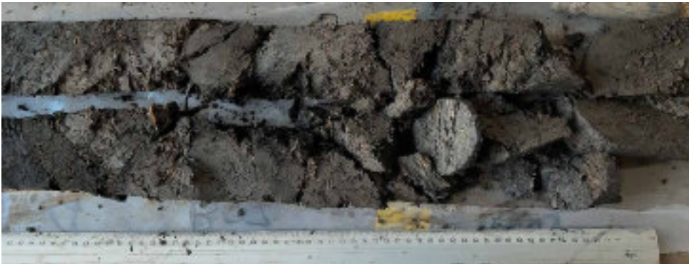
Foto WS-60 Boring B25B3034 (WSB07). Kern 8,42-9,0 m –MV. Veendetritus, donkerbruin, veel rietresten, spoor vivianiet, amorf, compact, veel platte rietstengels; vanaf 8,52 m: klei, bruin-grijs, veel rietresten, veenbrokje, onder 8,8 m brokkelig, rietmat van 1 cm dik op 8,8 m.
