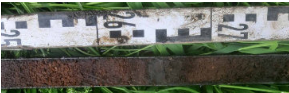
Foto ZB-10 Boring B19D2113 (veldnummer ZBo4). Veen, roodbruin, oligotroof met wollegras, heide en veenmos, tussen 2,65 en 2,68 m: klapklei, humeus, bruin, fijn gelaagd, scherpe onder- en bovengrens; vanaf 2,68 m: veen, donkerbruin, zwak amorf, rietveen met galigaan.
