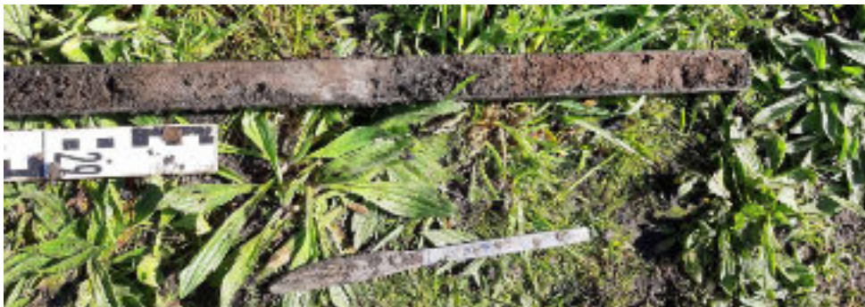
Foto OSW-05 Boring Bz6B3054 (SWo3). Donkergrijszwart, vuile, antropogene, scheepswerflaag; vanaf 2,95 m: klei, zwak humeus, licht bruingrijs, plantenresten, fijn doorworteld; van 3,0 tot 3,10 m: geoxideerde organische laag, donkergrijs; tussen 3,1 en 3,12 m: geelbruin, veel rietresten, platte rietstengels (rietmat?); vanaf 3,12 m: veen, bruin, zwak amorf, top kleiig, fijn doorworteld.
