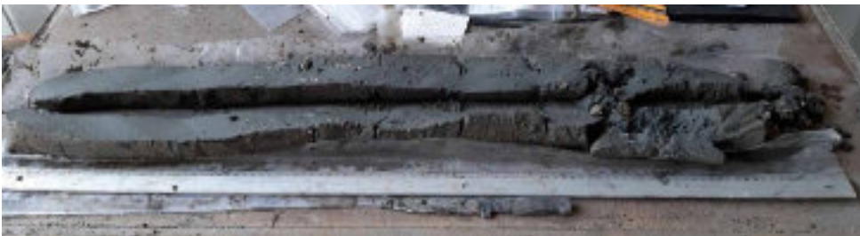
Foto WS-22 Boring B25B3029 (WSB02). Kern 8-9m –MV. Zand (Wormerafzettingen), kleiig, grijs, Cerastodermadoubletten, weinig Scrobiculariadoubletten, onduidelijk gelaagd, wadafzettingen.
