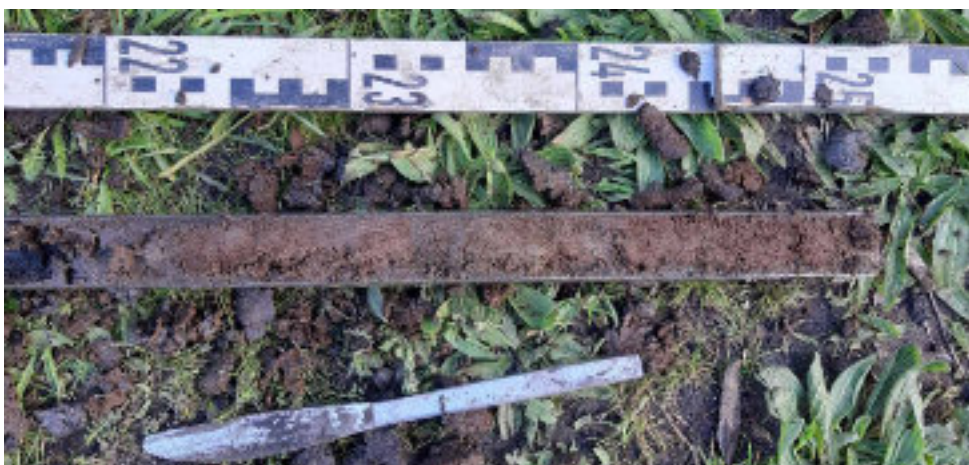
Foto OSW-06 Boring Bz6B3054 (SWo3). Veen, bruin, zwak amorf, fijn doorworteld.
