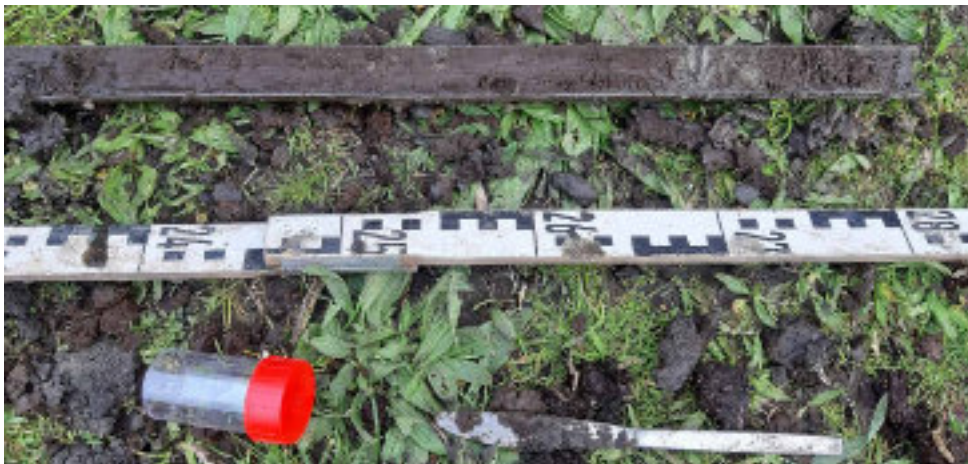
Foto OSW-08 Boring B26B3054 (SWo3). Gyttja (Zaanaafzetting), donkerbruin, met fijne plantenresten; vanaf 4,7 m: gyttja (Zaanaafzetting), zandig, donkerbruin, gelaagd met zeer fijn zand, grijs, verspoeld Wormerzand; vanaf 5,0 m: zand, zeer fijn, grijs, detritus, gelaagd met detritus, aan de basis erosief.
