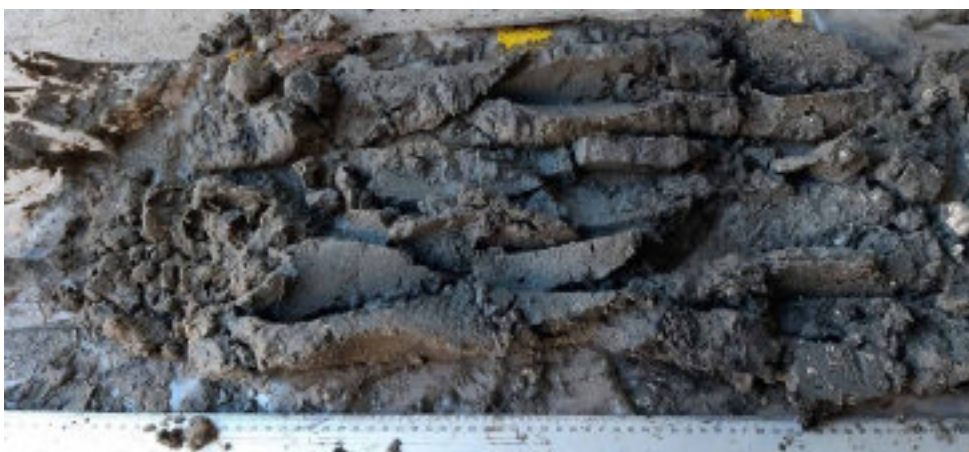
Foto WS-56 Boring B25B3039 (WSB14). Kern 11-11,5 m –MV. Zand, lichtgrijs, uiterst fijn, zwak humeus, schelpgruis, vrij homogeen, verspoeld Wormerzand.
