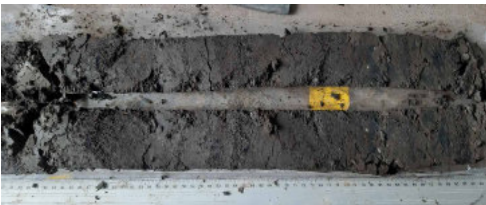
Foto WS-38 Boring B25B3033 (WSBo6). Kern 9,5-10 m –MV. Klei, donker bruingrijs, enkele zwarte vlekken, rietresten, veel detritus, spoor zoetwater en landschelpen, stukje zwanenmossel.
