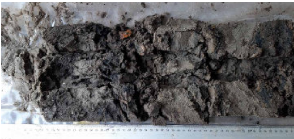
Foto WS-33 Boring B25B3033 (WSBo6). Kern 7-7,5 m –MV. Zand, uiterst fijn, zwak humeus, gelaagd met detritus, spoor schelpgruis, spoor baksteen.
