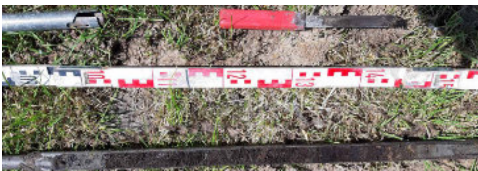
Foto SM-06 Boring B19D2103 (SMo9). Veen, roodbruin, zwak amorf, heide-, veenmos- en wollegrasveen; vanaf 2,4 m: veen (basis Hollandveen), donkerbruin, rietveen, redelijk ontwikkeld; vanaf 2,62 m: klei (Wormerafzetting), licht bruingrijs, matig slap, licht rietdoorworteld.
