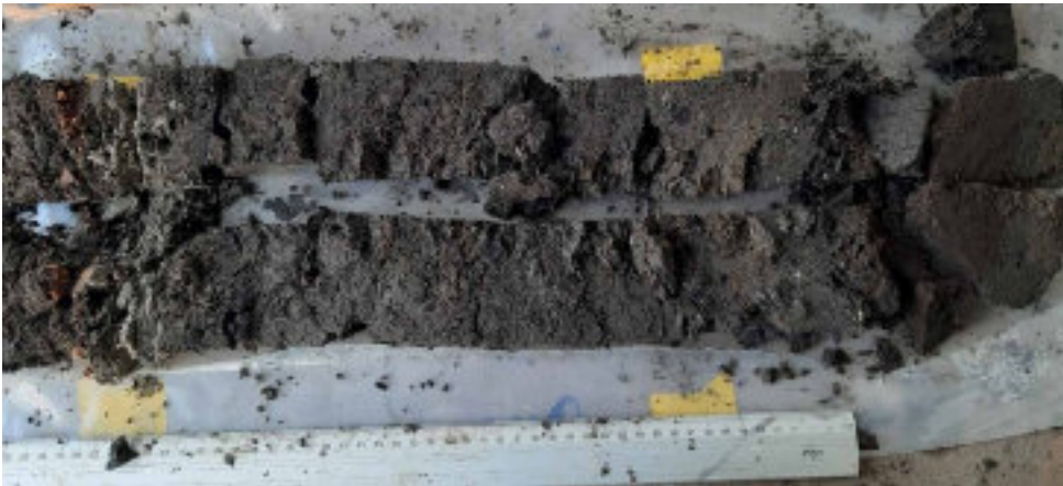
Foto WS-36 Boring B25B3033 (WSBo6). Kern 8,5-9 m –MV. Klei, sterk humeus, donkergrijs, stevig, rietresten, weinig zoetwater- en landschelpen, spoor botresten, veel detritus, smerig, zoetwaterslakjes en stukje bot op 8,90 m.
