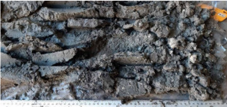
Foto WS-57 Boring B25B3039 (WSB14). Kern 11,5-12 m –MV. Zand, grijs, matig fijn, met schelpen lag-deposit: veel Cerastoderma edule en ook Macoma baltica , Scrobicularia plana en alikruikje; veelal enkelkleppig; geen archeologie.
