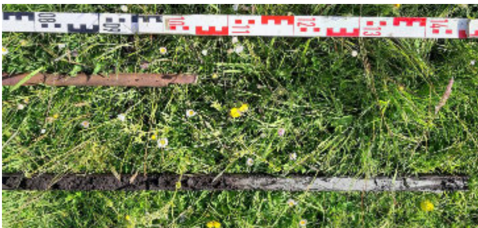
Foto EW-02 Boring B25B3057 (EW03). Detailopnamefoto EW-01: basis meerbodema-fzetting op Wormer-getijdsedimenten; het Hollandveen is hier volledig opgeruimd door erosie.
