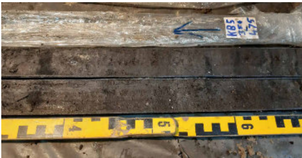
Foto OK-13 Detailopname van de plaggenophogingslaag onder de kerk (laag OL, af . 6.5) uit boring B25B3050 (KBo5), bestaande uit een afwisseling van humeuze en sterk humeuze klei en donker bruingrijze tot donkerbruine veenbrokken.
