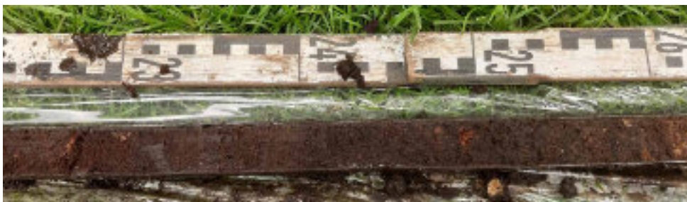
Foto ZB-15 Boring B19D2116 (veldnummer ZBo7). Detailopname foto ZB-14: traject tussen 1,95 tot 2,63 m: veen, donkerbruin, rietveen, redelijk tot goed ontwikkeld; vanaf 2,40 m: donkerbruin, matig amorf, rietveen met galigaan; vanaf 2,55 m: veen, roodbruin, oligotroof veen, matig ontwikkeld, niet zo rood.
