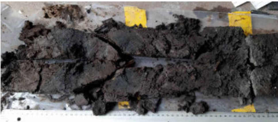
Foto WS-11 Boring B25B3030 (WSBo3). Kern 3-3,5 m –MV. Veenbrokken (meso-oligotroof en compact) en detritus, donkerbruin. 3,20-3,21: rietmat, platte, gestapelde rietstengels.
