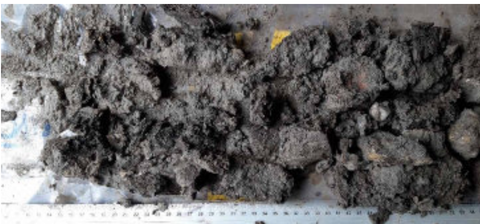
Foto WS-29 Boring B25B3033 (WSBo6). Kern 5-5,5 m –MV. licht bruingrijs, zand: matig fijn, spoor schelpgruis, basis baksteen, kiezels en puin.
