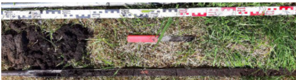
Foto SM-05 Boring B19D2103 (SMo9). Veen, donker zwartbruin, amorf, geoxideerd veen; vanaf 0,65 m: veen, donkerbruin, riet-zeggeveen met galigaan; vanaf 1,0 m: veen, donkerbruin, rietveen, redelijk ontwikkeld.
