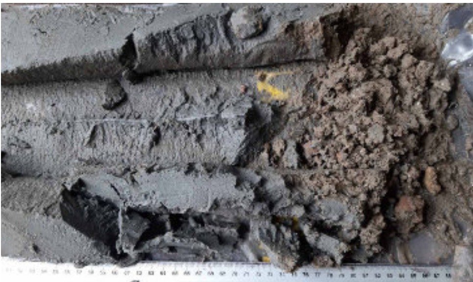
Foto WS-47 Boring B25B3039 (WSB14). Kern 5,5-6 m –MV. Zand (ophoogzand), uiterst fijn, zwak kleiig, grijs, homogeen; vanaf 5,80 m: zand, matig fijn, bruingrijs, ijzeroxide, spoor schelpgruis, baksteen en sintel.
