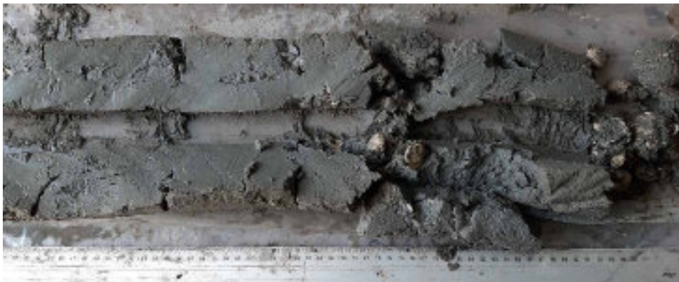
Foto WS-24 Boring B25B3029 (WSBo2). Kern 8,5-9 m –MV. Zie de beschrijving bij foto WS-18; vanaf 8,90 m: schelpen lag-deposit, hoofdzakelijk Cersatoderma edule .
