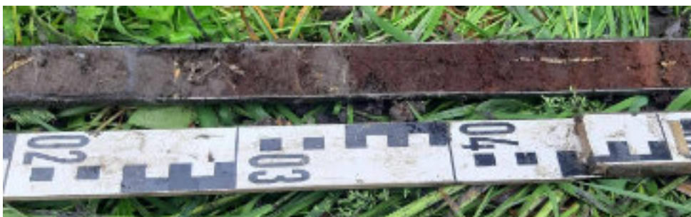
Foto ZB-07 Boring B25B3066 (veldnummer ZBo1). Detailopname foto ZB-06. Klei (Zaanafzetting), bruingrijs, wat gelaagd op kleur, matig humeus, rietdoorworteld, basis erosief; vanaf 3,35 m: veen, roodbruin, oligotroof veenmosveen met heide en wollegras, top fijne rietwortels (wordt snel donker door oxidatie).
