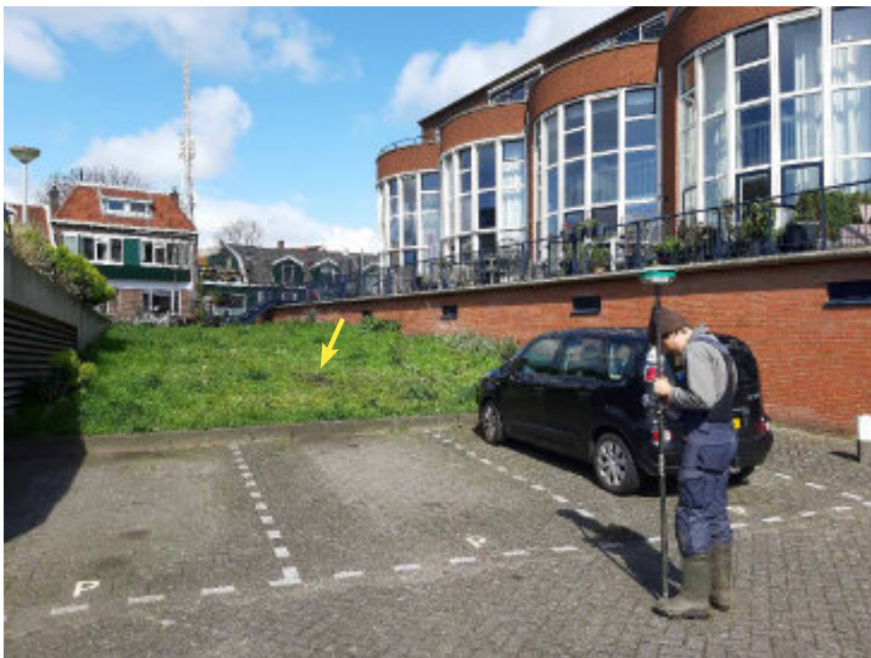
Foto OSW-02 Boorlocatie Bz6B3o54 (SWo3) in het grasveld (gele pijl) wordt ingemeten met GPS.
