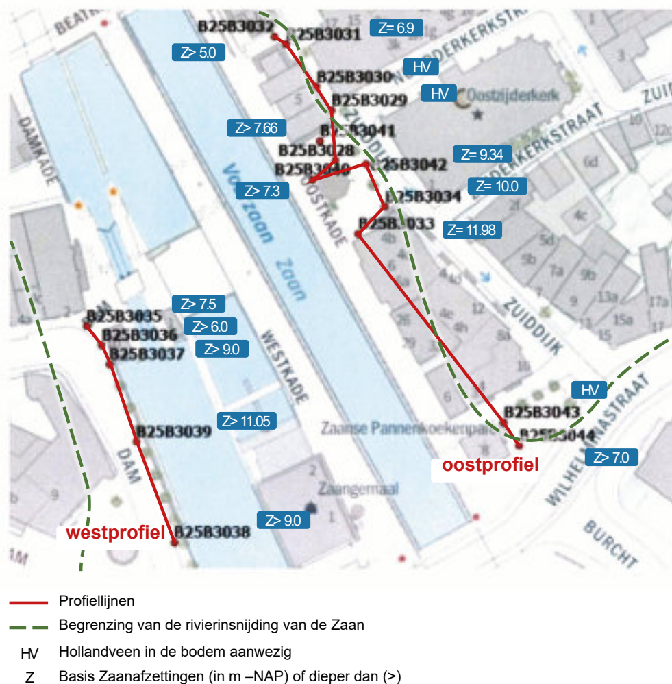
Afb. 5.1 Locatiekaart met de boringen bij de Wilhelminasluis en de ligging van de oost- en westprofielen (rode lijn). De boorlocaties waar Hollandveen is aangeboord en geulafzettingen van de Zaan ontbreken zijn aangegeven met de code HV. De Zaan heeft dus niet op deze plaatsen gelopen. De groene stippellijn geeft de begrenzing aan van de rivierinsnijding van de Zaan. In de blauwe vakjes is de diepte van de erosieve basis van de Zaanafzettingen (ofwel: de diepte van de Zaanbodem) aangegeven in m –NAP (Z = Zaanbodem aangeboord op de gegeven dieptemaat; > betekent dat de Zaanbodem niet is aangeboord, maar dieper ligt dan de aangegeven waarde).
