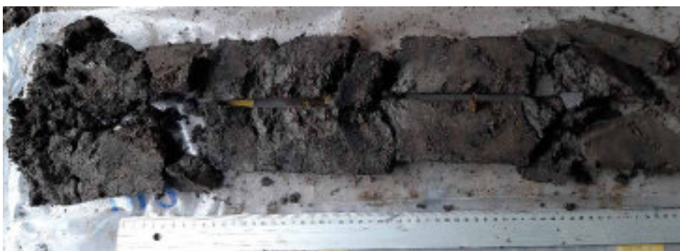
Foto WS-31 Boring B25B3033 (B6). Kern 6-6,5 m –MV. Klei, sterk humeus, donker bruingrijs, rietresten, detritus, met brokkenveen, gyttja-achtig.
