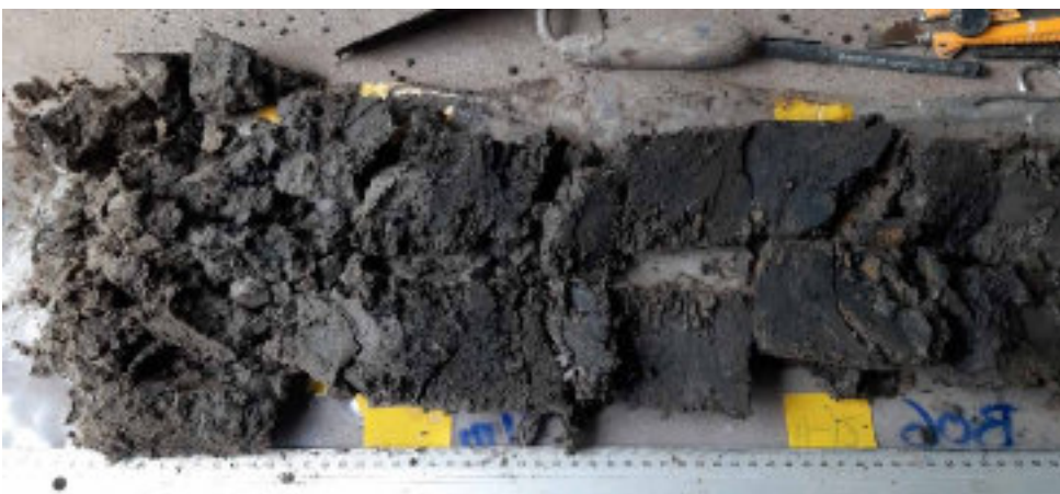
Foto WS-41 Boring B25B3033 (WSBo6). Kern 11-11,5 m –MV. Zand, matig fijn, 1 kokkel, mogelijk naval; vanaf 11,20 m: klei, sterk humeus, donkergrijs, spoor zoetwater- en landschelpen, baksteen, zwarte vlekken, platte verslagen plantenresten, enkele zoetwaterslakjes.
