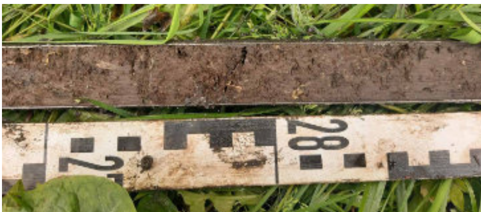
Foto ZB-05 Boring B25B3066 (veldnummer ZBo1). Detailopname foto ZB-04, klei, grijsbruin, venig, rietdoorworteld, vrij stevig.
