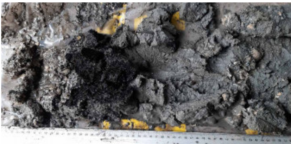
Foto WS-43 Boring B25B3033 (WSBo6). Kern 12-12,5 m –MV. Schelpen lag-deposit (Zaanaafzettingen), veel Cerastodermasp., enkele dubbelkleppige schelpen, brok verslagen oligotroof veen; vanaf 12,33 m: zand (Wormer-ophoogafzettingen), zeer fijn, grijs, spoor schelpresten, homogeen.
