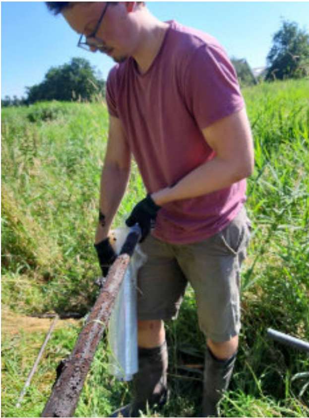
Foto ZB-17 Veldbemonstering van boring B19D2112 (ZBo3) voor laboratoriumonderzoek.
