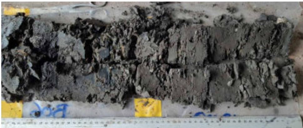
Foto WS-42 Boring B25B3033 (WSBo6). Kern 11,5-12 m –MV. Klei (Zaanaafzettingen), sterk humeus, donkergrijs, spoor zoetwater- en landschelpen, baksteen, zwarte vlekken, platte verslagen plantenresten; vanaf 11,70 m: klei, sterk humeus, donker grijsbruin, spoor detritus, compact, platig, geen wortels; vanaf 11,98 m: klei, grijs, zandig (Zaanaafzettingen), Cerastodermaedule.
