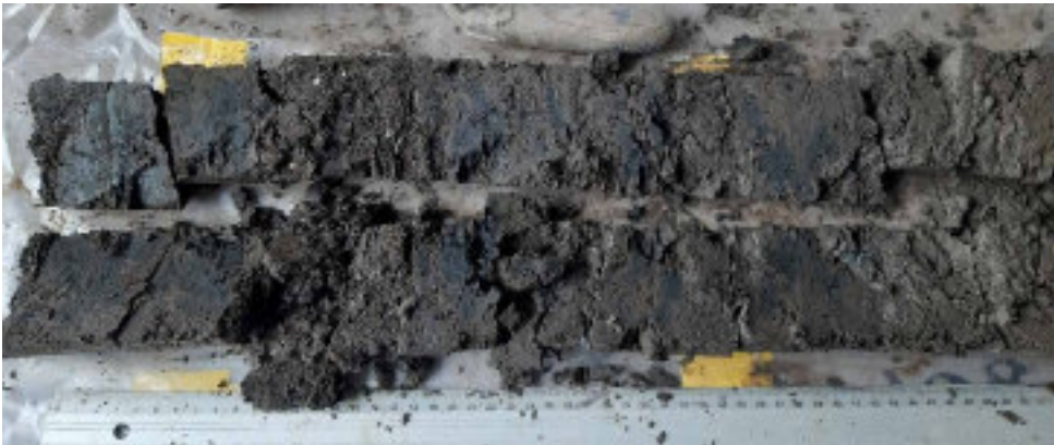
Foto WS-39 Boring B25B3033 (WSBo6). Kern 10-10,5 m –MV. Klei, donker bruingrijs, rietresten, spoor zoetwater en landschelpen, veel detritus, vanaf 10,10 m: donker bruingrijs, veel detritus, rietresten, spoor zoetwaterschelpen, Bythinia slakjes, vanaf 10,18 m: klei, bruingrijs, sterk humeus, zwarte sulfaatvlekken, veel detritus; zandlaagjes op 10,26 en 10,35 en 10,42 m.
