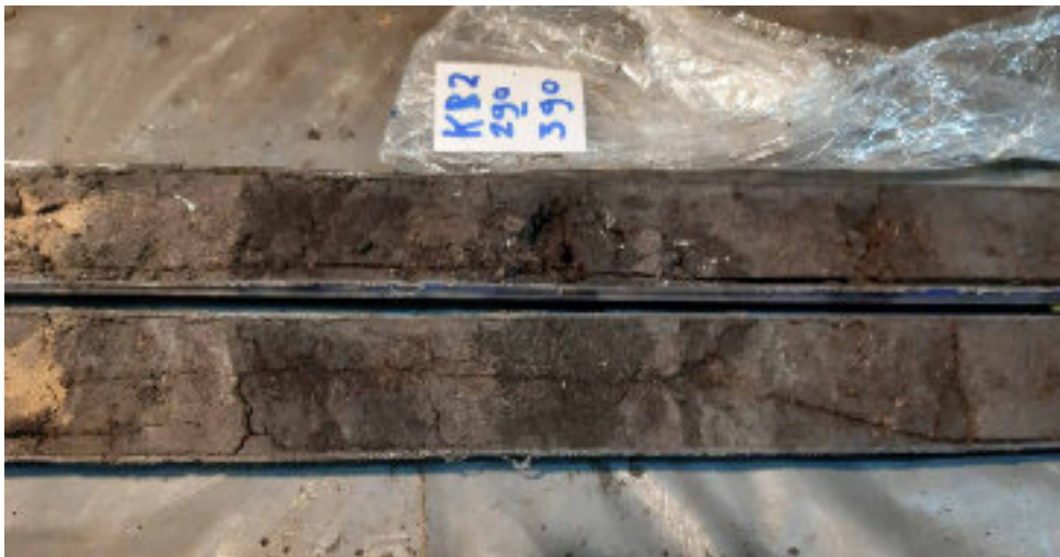
Foto OK-12 Detailopname van de plaggenophogingslaag onder de kerk (laag OL, af . 6.5) uit boring B25B3051 (KBo2), bestaande uit gelaagde humeuze klei en venige brokken (plaggen).
