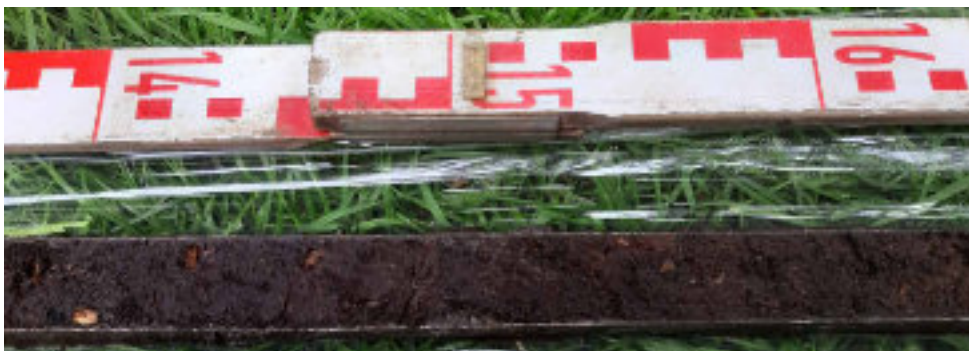
Foto ZB-12 Boring B19D2116 (veldnummer ZBo7). Veen, donkerbruin, matig amorf, rietveen met enkel takje tussen 1,35-1,45 m.
