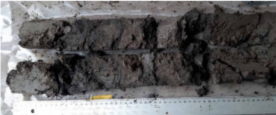
Foto WS-27 Boring B25B3033 (WSBo6). Kern 4-4,5 m –MV. Klei, zwak humeus, licht bruingrijs, spoor plantenresten, vanaf 4,10 m: veendetritus, kleiig, donker grijsbruin, vanaf 4,20 m: klei, donker bruingrijs, weinig rietresten, veel detritus, smerig.
