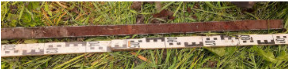
Foto ZB-06 Boring B25B3066 (veldnummer ZBo1). Klei (Zaanafzetting), bruingrijs, wat gelaagd op kleur, matig humeus, rietdoorworteld, basis erosief; vanaf 3,35 m: veen, roodbruin, oligotroof veenmosveen met heide en wollegras, top fijne rietwortels.
