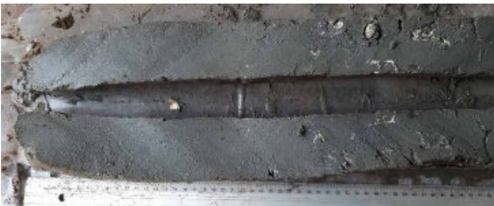
Foto WS-23 Boring B25B3029 (WSB02). Kern 8-8,5m –MV. Detailopname van het bovenste deel van foto WS-17. Zand (Wormerafzettingen), kleiig, grijs, hoofdzakelijk Cerastodermadoubletten en weinig Scrobiculariadoubletten.
