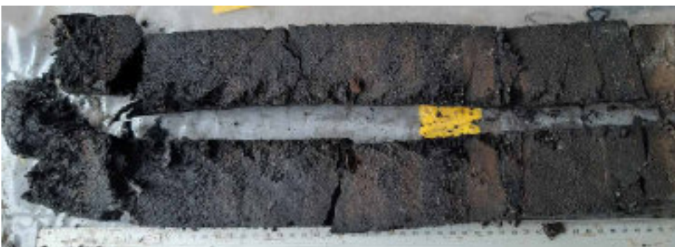
Foto WS-18 Boring B25B3030 (WSB03). Kern 6-6,5 m –MV. Veen (Hollandveen), donkerbruin en beetje roodbruin, oligotroof, heide.
