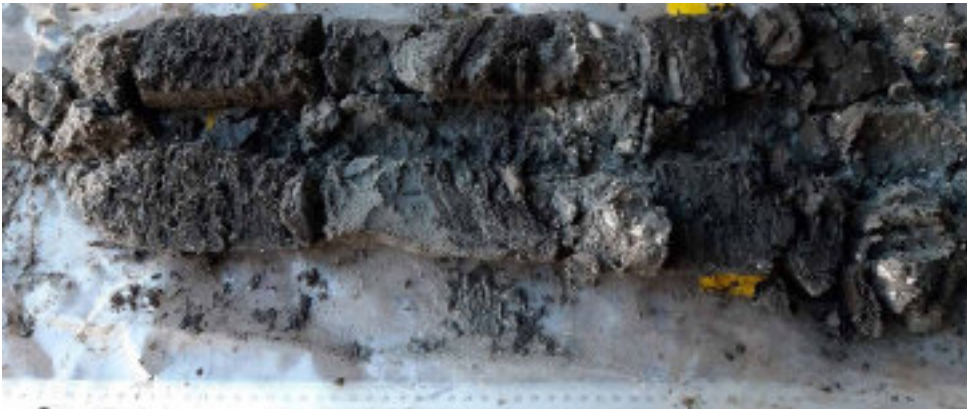
Foto WS-58 Boring B25B3039 (WSB14). Kern 12-12,5 m –MV. Afwisseling van veendetritus, sterk zandig, grijsbruin, schelpgruis, fijne veendetritus, matrix is sterk humeus/amorf, platig afgezet en zand, grijs, uiterst fijn, gelaagd met spoor schelpgruis, en detritus en schelpen lag-deposit met veel Cerastoderma edule .
